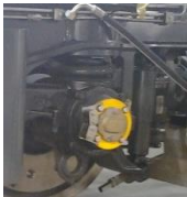
Primärfeder -> (Schraubfeder und Dämpfer)
