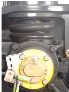
Primärfeder -> (Schraubfeder und Dämpfer)
