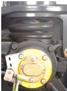
Primärfeder -> (Schraubfeder und Dämpfer)
